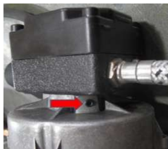
شکل ۷) پیچ اتصال پمپ به شافت موتور
