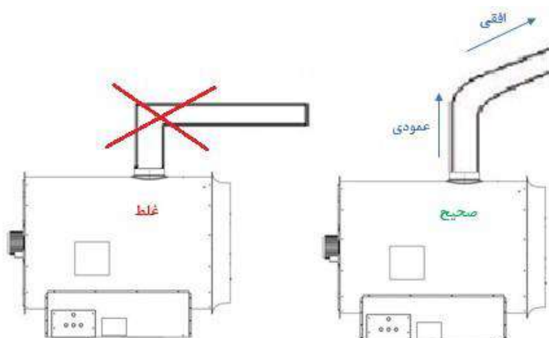
شکل ۹) طرز صحیح قرارگیری لوله دودکش
